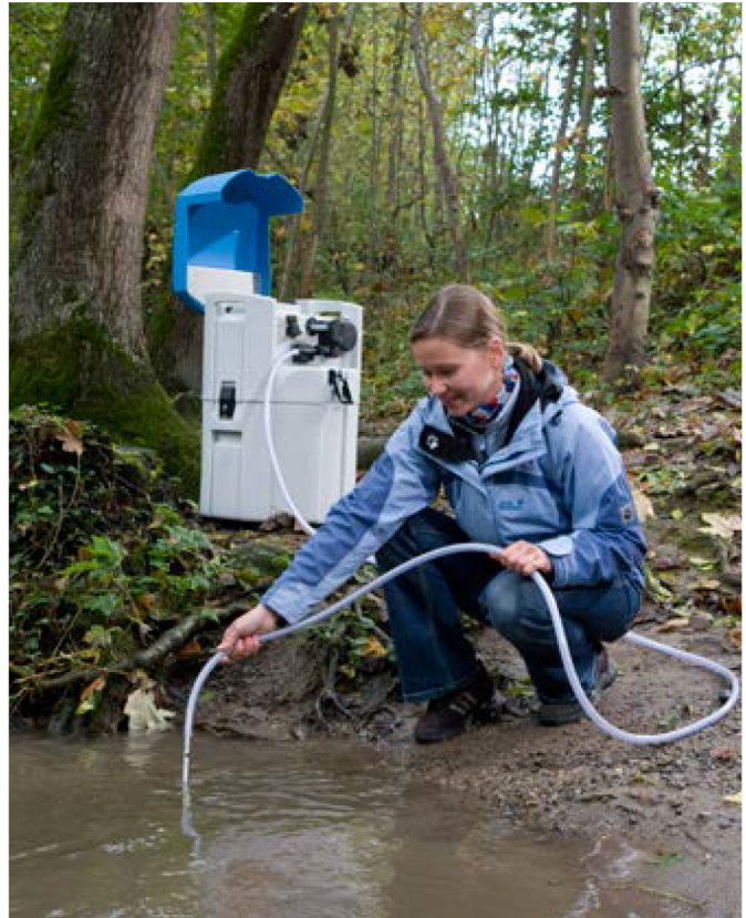
Rápido y fácil: Muestreo directo en las orillas del arroyo con el Liquiport CSP44 móvil
